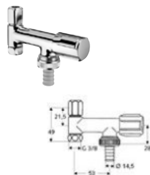
DIANA Nebenanschlußventil/Geräteventil mit RV 3/8" mit Rückflussverhinderer, und Schlauchverschraubung, Dimension DN 10 G 3/8 IG x DN 10 G 3/8 AG, verchromt, (DI407915500) 50,50 €
