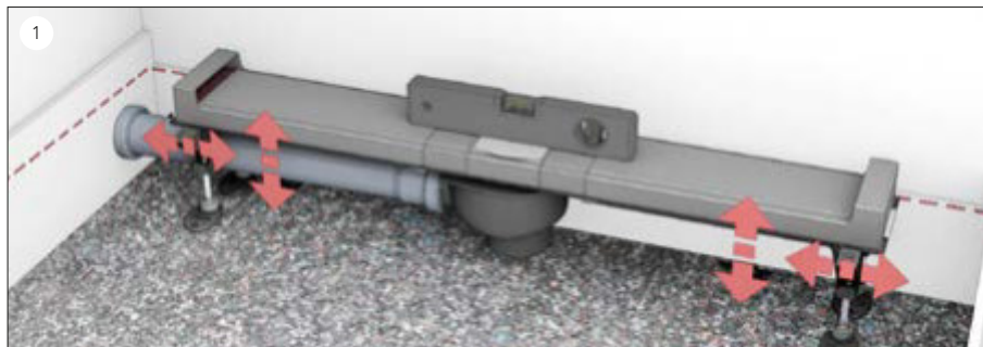
Die geschlossene Rinne wird im Raum platziert und ausgerichtet. Mit den optional erhältlichen Montagefüßen lässt sich das einfach bewerkstelligen. Das Abflussrohr kann platzsparend unter der Rinne verlegt werden.
